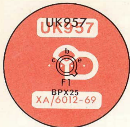
Fig. 2/a - Montaggio del fototransistore.
