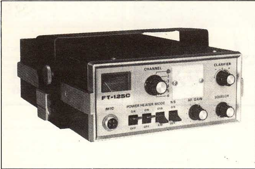
Fig. 3 - Ricetrasmittitore Sommerkamp FT125 per la gamma marina 1600 ÷ 9000 kHz funzionante in SSB/AM-CW, uscita 50 W, a sei canali compresi quelli di emergenza 2182 kHz e 7075 kHz.
